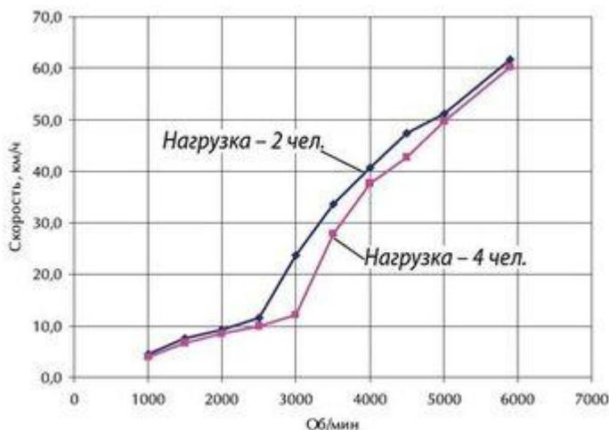
*Мотор Honda BF60, винт с шагом 16 дюймов*
